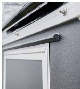
Protection anti-pluie grâce à des gouttières au-dessus des portes et au-dessus du pont.
